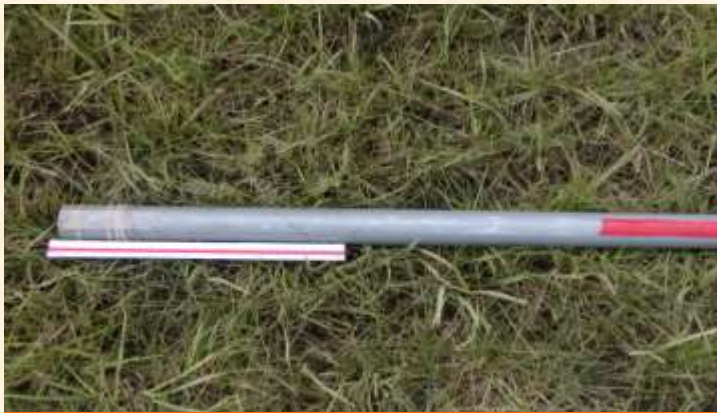
Waterhoogtemeter achter damconstructie
